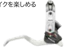
「サーボウェーブアクション」でブレーキとコントロール性が高められたBL-M775
