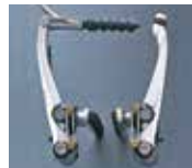
大きな制動力を発揮するVブレーキ
