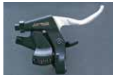
変速操作に優れた「ラピッドファイヤー」シフトレバー
