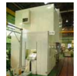
騒音を軽減するカバーを設置するなどの対策を施しています(シマノ本社)
