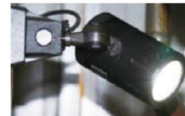
照明をLEDに変更し、使用電力を月間1625.4kWhから813.6kWhに削減しました(シマノクンシャン：中国)
