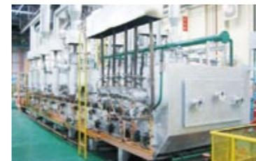
炉の高温断熱塗装によって、熱損失が改善し、年間50tのCO<sub>2</sub>の削減に成功しました(シマノ下関工場)
