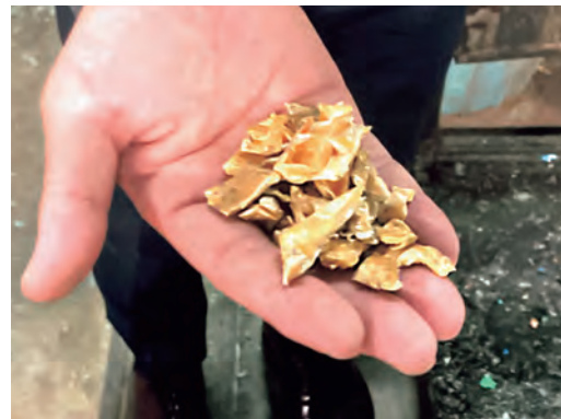
引き取られたコンテナは粉碎処理され、素材として再利用されます
