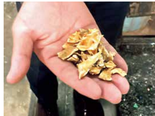
供应厂商将回收的周转箱进行粉碎处理，作为材料重复利用。
